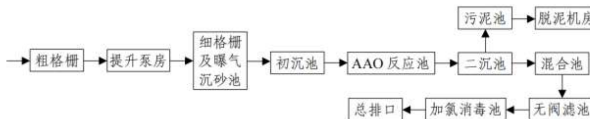
图4-2 污水处理厂实际工艺流程示意图
